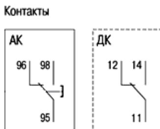
Рисунок 8 — Электрические схемы дополнительного и аварийного контактов
